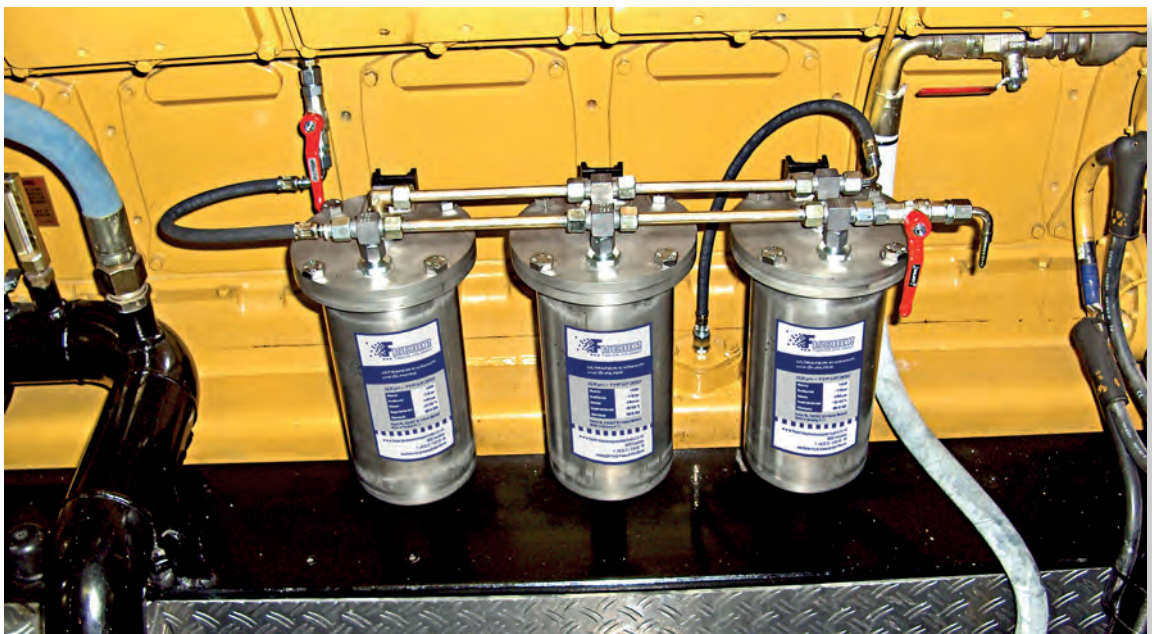
Ultrafein-Filterung von Schmieröl ■ © Horst Weiland
