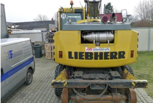
Der Rußpartikelfilter findet Platz im Heckgewicht und ersetzt den Original-Schalldämpfer.
